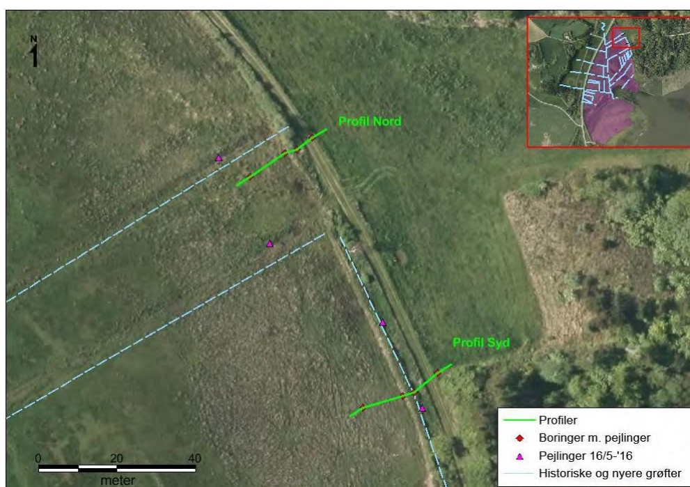
Figur 5-9. Borerer hvor det overfladenære grundvandsspejl er målt i løbet af foråret og sommeren 2016. Desuden er vist supplerende målinger af grundvandsspejlet fra maj 2016.
